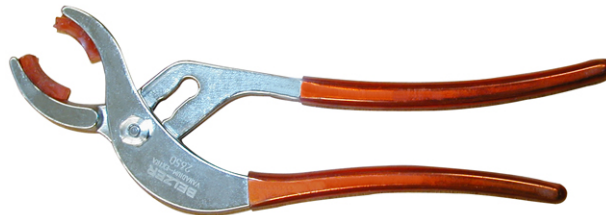
Exemple : Pince spéciale pour serrer les raccords des énergies et des codeurs moteurs
