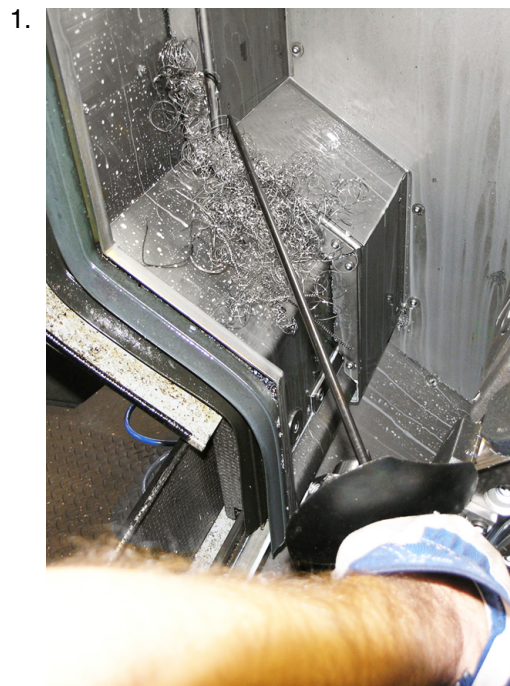
Exemple : 1 Enlèvement des nids de copeaux à l'aide d'outils appropriés (crochet p.ex.)
