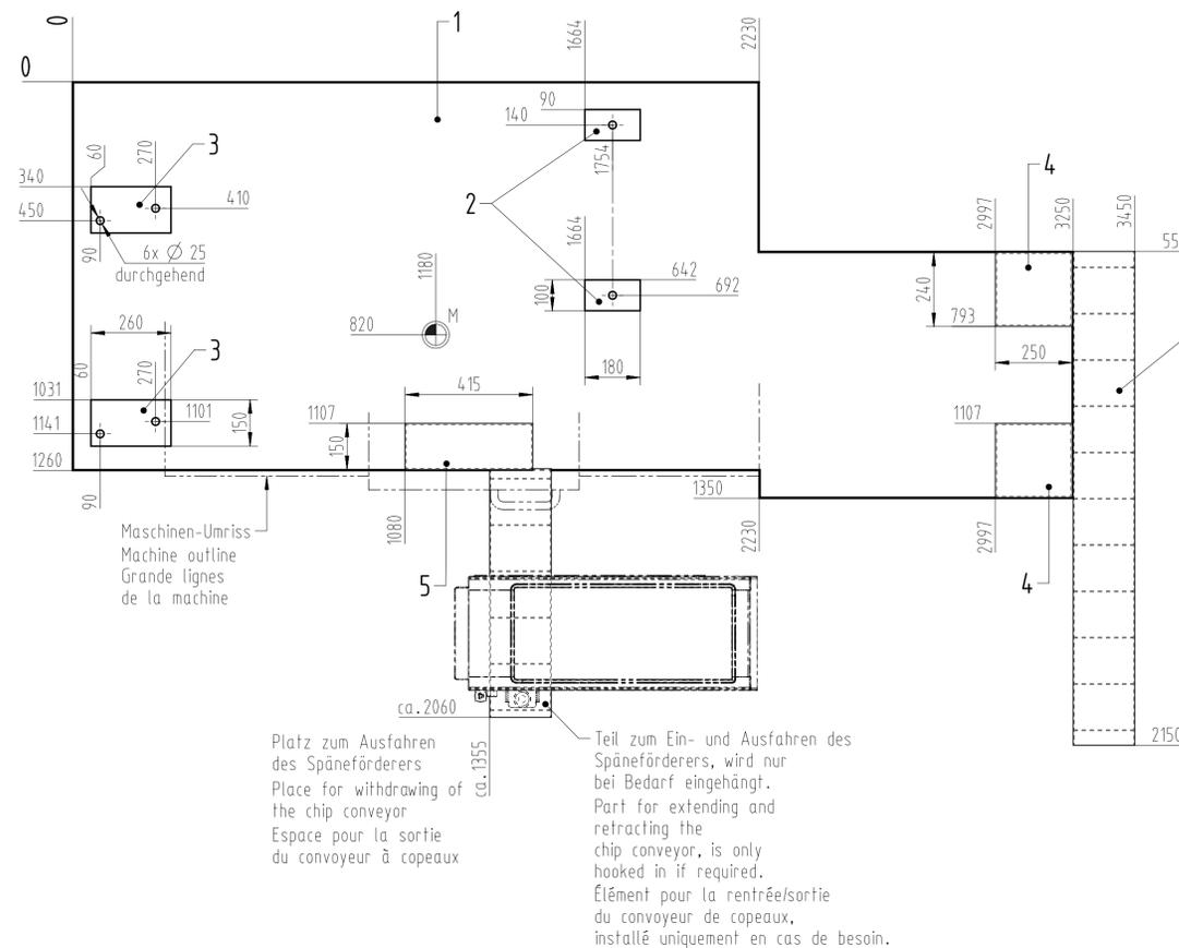
Die Tropfwanne gemäß Zeichnung ist ausgelegt für die Aufstellung der Grundmaschine einschließlich Späneförderer. Für Reinigungsanlage, Werkstoffnachschub und weitere Anbaugeräte sind bei Bedarf weitere Tropfwannen nötig. Nicht berücksichtigt sind individuelle Gegebenheiten, wie z.B. Breite der Umfassung der Maschine, eingeleger Laufrost, Platzverhältnisse sowie die Aufstellung externer Ausrüstungskomponenten wie z.B. Werkstückhandhabung, etc.
