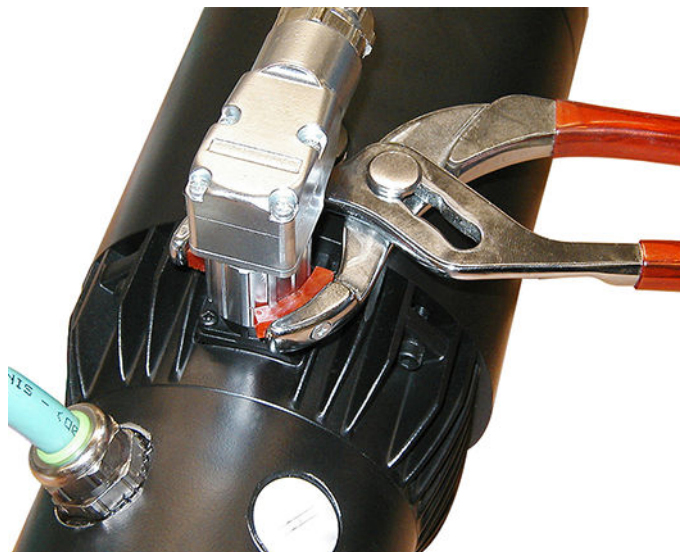
Exemple : Serrage d'un connecteur moteur
