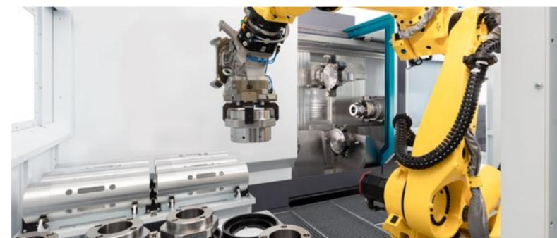
La cellule de robot iXcenter permet d'alimenter ou d'évacuer les pièces brutes et/ou usinée rapidement, avec fiabilité et souplesse.
